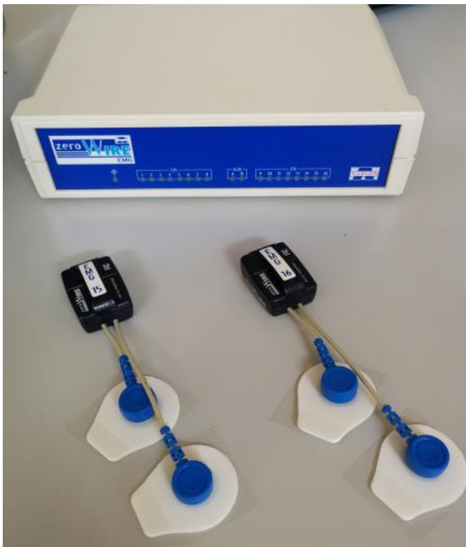
Figure 7 : appareil EMG sans fil avec électrodes de surface en configuration bipolaire
