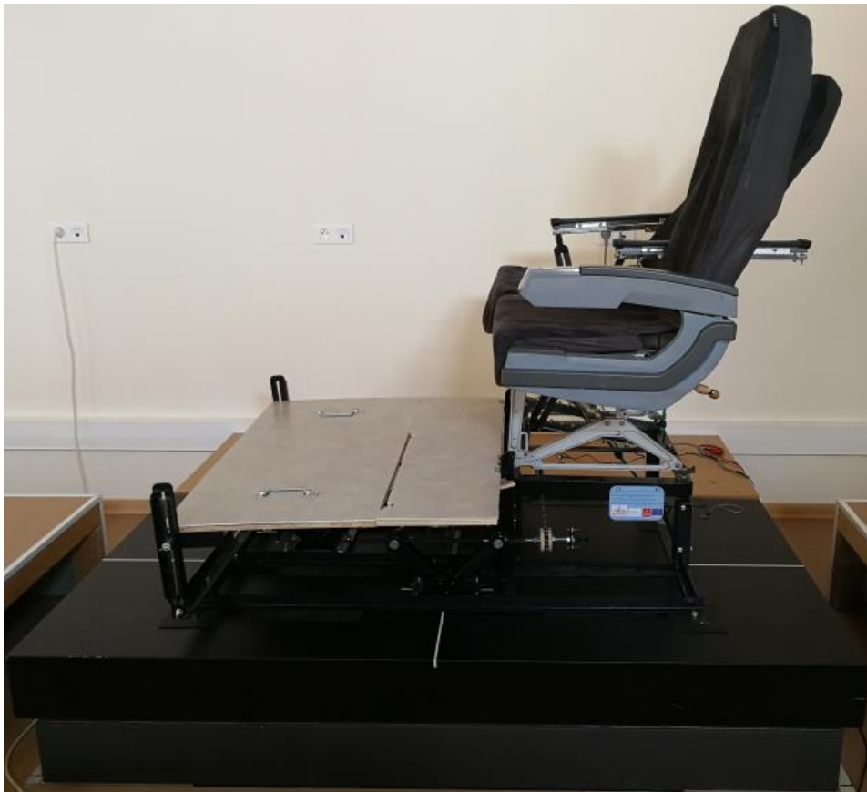
Figure 2 : plateau de force d'1 m x 2 m accueillant un prototype de siège d'avion
