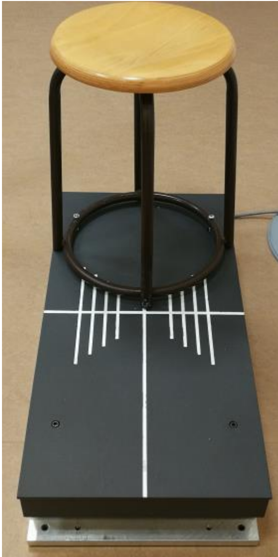
Figure 1 : plateau de force de 40 cm x 80 cm équipé d'un tabouret, destiné à l'analyse du transfert assis-debout
